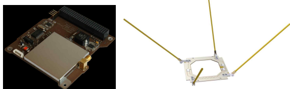
그림 1 CANYVAL-X 탑재 예정인 GomSpace사의 NanoCom 통신 시스템
